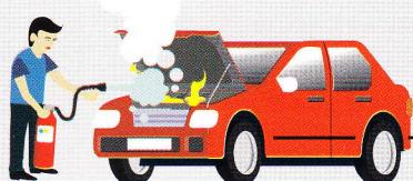
เมื่อไฟเริ่มงับ ให้ปิดฝ่ากระปรง โดยใช้ผ้ารองหรือสมุดจดมือ หัวมอนใช้ดับเพลิงเคมีฉีดพ่นให้ทั่วทั้งเครื่องไฟดับสนิท จึงค่อยดอดดับข้ามแบตเตอรี่ออก เพื่อป้องกันมิให้เป็นไฟลุกตามเพิ่มขึ้น
