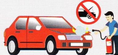
กรณีไฟไหม้ใหญ่จากฝ่ากระปรงให้ปลดล็อกฝ่ากระปรง และใช้ดับเพลิงเคมีฉีดพ่นผ่านช่องฝ่ากระปรงที่แม้มไฟได้ ห้ามเปิดฝ่ากระปรงในทันที เพราะจะทำให้ไฟลุกมาภายใน
