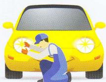
ตรวจสอบสัญญาณไฟให้เป็นไฟส่องสว่างทุกด้วง ทั้งไฟหน้าไฟท้าย ไฟตัดหมอก ไฟสูง และไฟเลี้ยว
