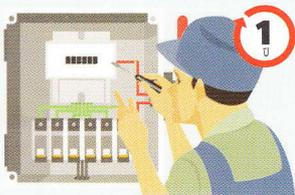
หมั่นตรวจสอบแผงควบคุมไฟฟ้าอย่างน้อยปีละ 1 ครั้ง โดยเฉพาะขั้วต่อสาย การเข้าสาย และจุดสัมผัสต่างๆ ต้องขันให้แน่น เพื่อไม่ให้เกิดความร้อนสูงจนทำให้เกิดไฟฟ้าลัดวงจร
