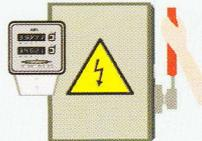
ปรับตั้งขนาดของอุปกรณ์ป้องกันกระแสไฟฟ้าลัดวงจร อาทิ ฟิวส์ เบรกเกอร์ ต้องเลือกขนาดที่สามารถตัดวงจรไฟฟ้าได้ทันทีที่ใช้กระแสไฟฟ้าเกินขนาด อีกทั้งมีพิสัยในการตัดกระแสไฟฟ้า ไม่ต่ำกว่าค่ากระแสไฟฟ้าที่ทำให้เกิดไฟฟ้าลัดวงจร รวมถึงสอดคล้องกับแรงดันไฟฟ้าที่ใช้งาน
