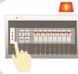
เป็นอุปกรณ์เปิด - ปิดการใช้งานไฟฟ้าในขณะใช้งานปกติ รวมถึงสามารถตัดกระแสไฟฟ้าลัดวงจรได้โดยอัตโนมัติ
