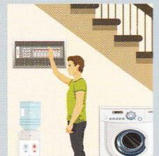
เลือกใช้เบรกเกอร์และฟิวส์ให้เหมาะสมกับปริมาณกระแสไฟฟ้า เพื่อป้องกันกระแสไฟฟ้าลัดวงจรจากการใช้ไฟฟ้าเกินขนาด ไม่ใช้เบรกเกอร์ที่มีค่าแอมป์สูงเกินไป เพราะหากกระแสไฟฟ้าวรัวไหล เบรกเกอร์จะไม่ทำงาน ทำให้สายไฟเกิดความร้อนสูงและเพลิงไหม้ได้
