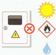
ติดตั้งแผงควบคุมไฟฟ้าในตำแหน่งที่ปลอดภัย ซึ่งสามารถเข้าถึงได้ง่ายและมีอากาศถ่ายเทสะดวก และอยู่ห่างจากวัสดุที่เป็นเชื้อเพลิง โดยอยู่สูงจากพื้นในระดับที่น้ำท่วมไม่ถึง ไม่อยู่ใกล้แนวท่อน้ำ เพื่อป้องกันอันตรายกรณีท่อน้ำชำรุด
